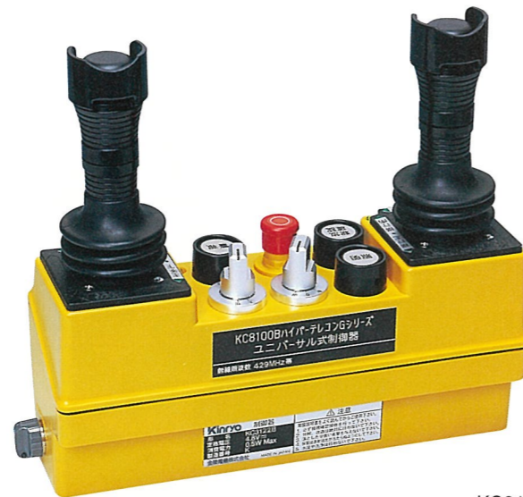
制御器 KC312□B UVH (ユニバーサルハンドル式) W260×H115×D75 mm 約1.7kg (突起部除く)
